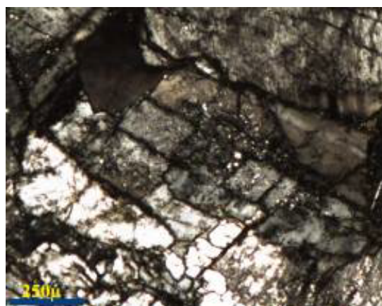
شکل ۴ سریسیتی شدن ارتوز در افق Crt (راست) و فلدسپار آلبیتی که در طول سطوح رخ خود در حال تبدیل به سریسیت است (چپ) در پدون حاصل از سنگ مادر گرانیت - XPL
