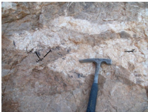
شکل ۱۰ رشد دوباره‌ی کلسیت در فضاهای خالی موجود در سنگ کربناتی.
