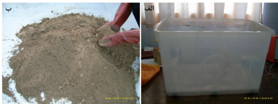
شکل ۴ الف. تانک پلاستیکی مورد استفاده در مدل آزمایشگاهی ب. آماده‌سازی خاک با تهیه‌ی مخلوط با نسبت مشخص از ماسه و رس.
