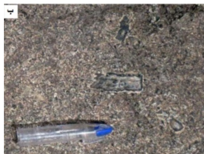
شکل ۵ (الف) زینوکریست‌های آندالوزیت در یک مونزوگرانیته-گرانودیوریت، (ب) زینوکریست‌های آندالوزیت در حال تبدیل به سیلیمانیت با یک حاشیه‌ی غنی از اسپینل در سنگ‌های دیوریتی ناحیه‌ی خاکو در منطقه همدان.
