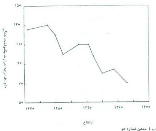
شکل ۵ نمودار تغییرات دماهای متوسط یکنواخت شدگی سیالات درگیر نسبت به ارتفاع.
