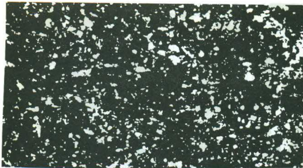
شکل ۳ نمای مقطع نازک مارن زردرنگ (PPL×40).
