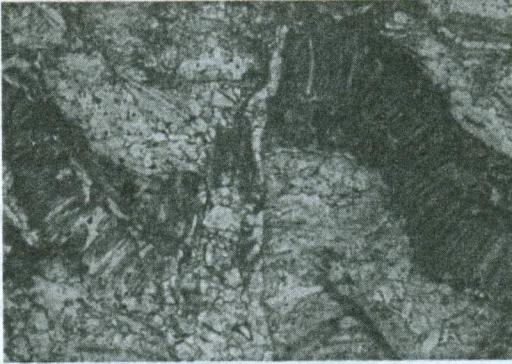
شکل ۳ برش خوردگی رگچه‌های کربناتی در ارتولیستونیت‌ها (XPL, \times 12/5 ).
