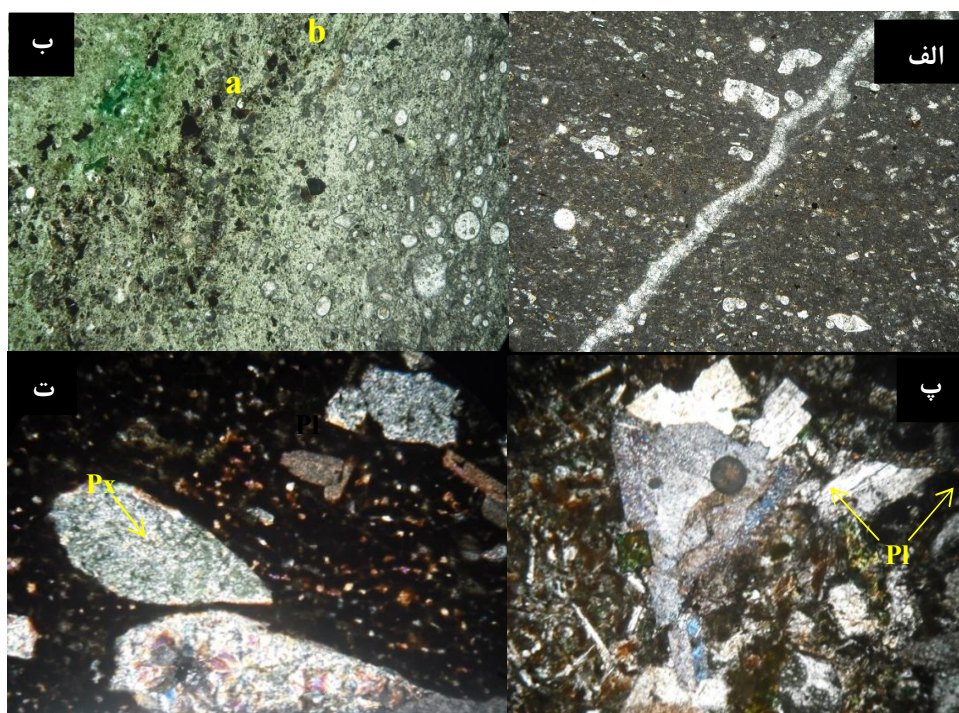
شکل ۲ الف- تصویر میکروسکوپی کانی‌سازی هماتیت و مگنتیت در داخل سنگ آهک، ب- تصویر میکروسکوپی سنگواره‌های گلوبوترونکانا (a) و گانسرینا گانسری (b) در داخل سنگ آهک، پ - تصویر میکروسکوپی آندزیت- بازالت با بافت بادامکی که حفرات توسط سیلیس پر شده‌اند، ت- تصویر میکروسکوپی بافت گلوپورپوری در پیروکسن هورنبلند آندزیت که پیروکسن به کلریت تبدیل شده است و هورنبلندها به اکسیدهای آهن تجزیه شده‌اند.
