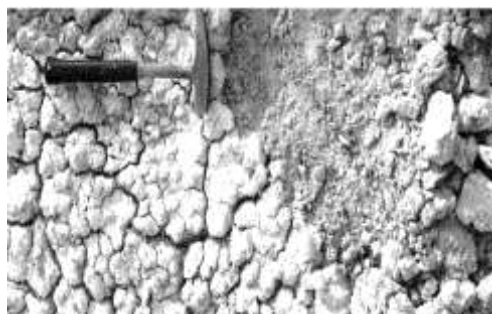
شکل ۶ ترک‌های پدید آمده در اثر از دست دادن آب از بنتونیت متورم شده (سمت چپ عکس). برداشت لایه‌ای به ضخامت حدود ۵ سانتیمتر بنتونیت توده‌ای و دانه‌دار آشکار می‌شود (در سمت راست عکس).
