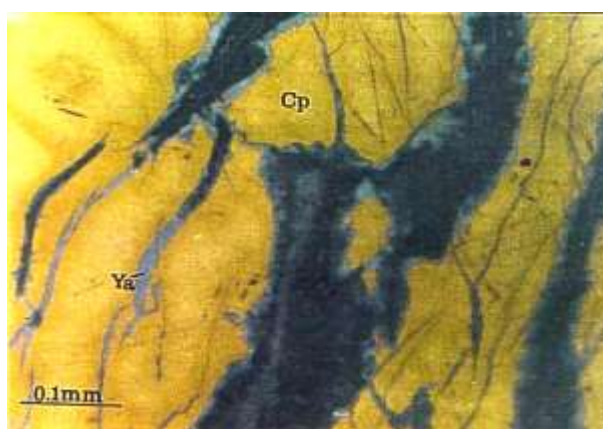
شکل ۳ تصویر نور پلاریزه از مقطع صیقلی. گسترش کانی یاروویت (Ya) بصورت رگچه‌هایی درون کالکوپیریت (Cp).
