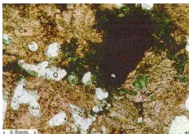
شکل ۹ وجود هاله‌ای از مالاکیت (Ma) اطراف اکسید و هیدروکسیدهای آهن (شکل مجازی کالکوپریت).
