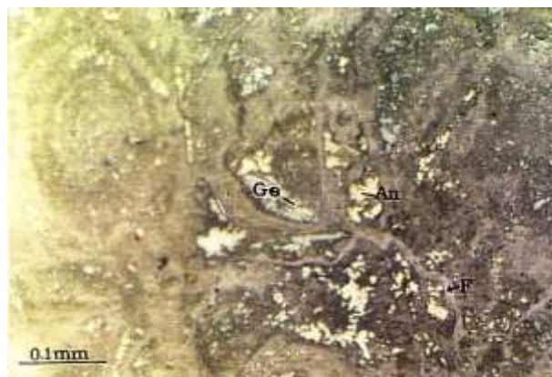
شکل ۶ قطعه کالکوپیریت تماماً به محصولات ثانوی دگرسان شده است. آنیلیت (An) به رنگ سفید و گیریت (Ge) به رنگ آبی کم رنگ درون اشکال کاذب کالکوپیریت دیده می‌شود. F محل شکستگی را نشان می‌دهد.
