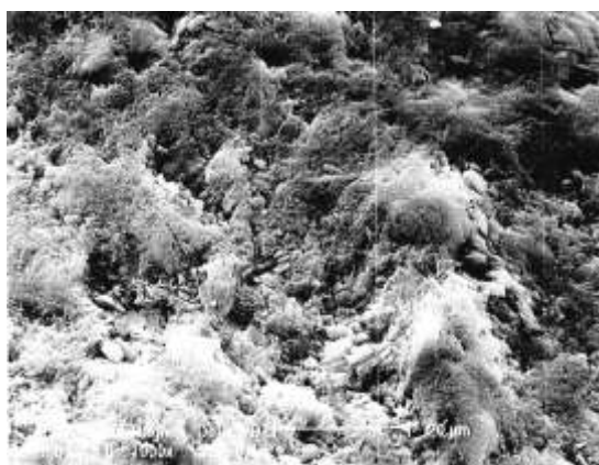
شکل ۴ تصویر SEM نمونه زئولیت بار شده، CFC.
