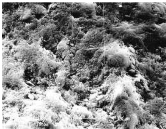
شکل ۴ تصویر SEM نمونه زئولیت بار شده، CFC.
