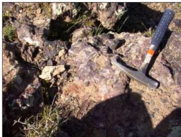
شکل ۴ کوارتزهای طلادار همراه با مگنتیت تنورچه به صورت رگه‌ای، رگچه‌ای و پراکنده در مگنتیت.
