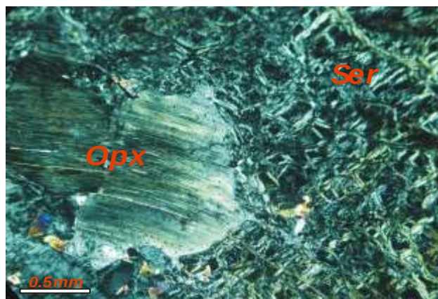
شکل ۸ بافت غربالی در سنگهای سرپانتینیتی حوالی روستای سرآسیابان. Ser = سرپانتین، Opx = ارتوپروکسن تبدیل شده به بستیت.
