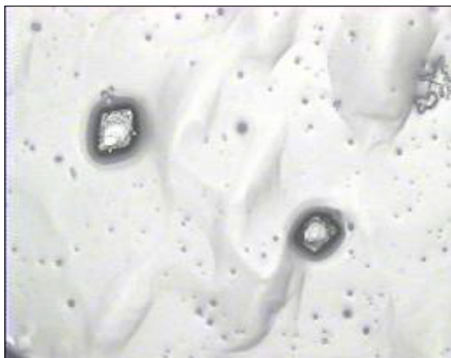
شکل ۴ عکس ۵۰۰ برابر شده بلور TGSP.
