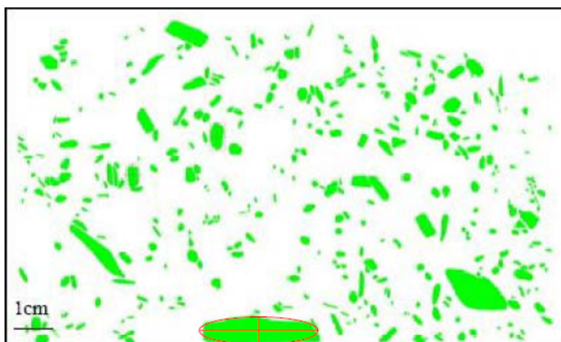
شکل ۴ تصویر اسکن شده آمفیبول‌های موجود در یکی از نمونه‌های مورد بررسی.
