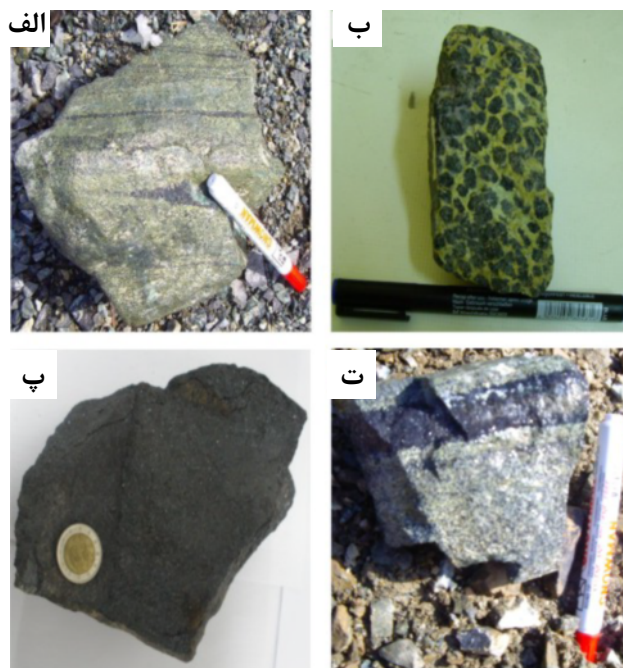
شکل ۲ بافت‌های اولیه در نمونه‌های دستی (الف) بافت افشان (پراکنده) که در بعضی جاها به بافت نواری تبدیل شده است (ب) بافت گرهمی (نودولار) (پ) بافت توده‌ای (متراکم) (ت) بافت نواری در کانسنگ کرومیت و تبدیل لایه‌های کرومیت به لایه‌های سیلیکاتی.
