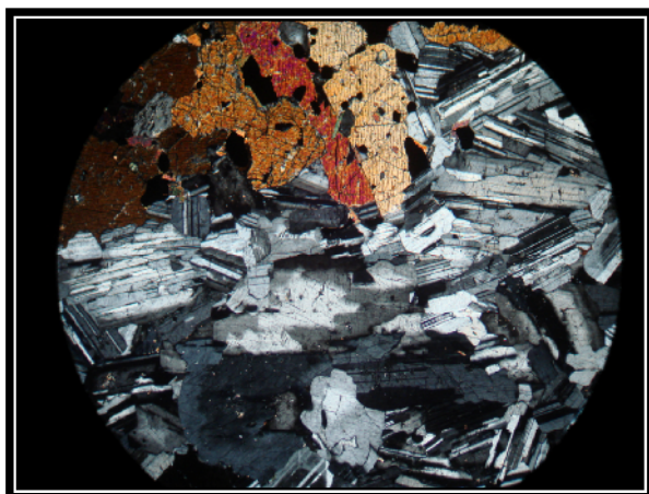
شکل ۱۲: نمایی از بافت برگه‌ای آذرین در گابروی لایه‌ای گروه سوم (در نور XPL)
