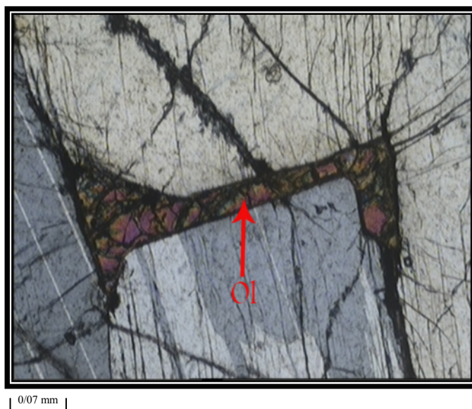
شکل ۹ بلور اینترکومولوس اولیوین که بین بلورهای پلاژیوکلاز متبلور شده است.
