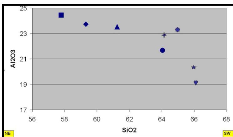
شکل ۵ تغییرات میزان آلومینا نسبت به میزان سیلیس.
