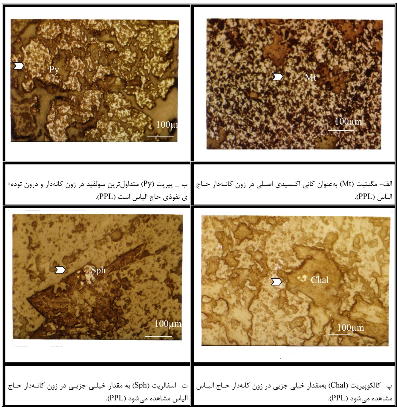
شکل ۶ مگنتیت به عنوان متداول‌ترین اکسید، و پیریت، کالکوپیریت و اسفالریت سولفیدهای موجود در مقاطع صیقلی به زون کانه‌دار منطقه‌ی مورد بررسی هستند.
