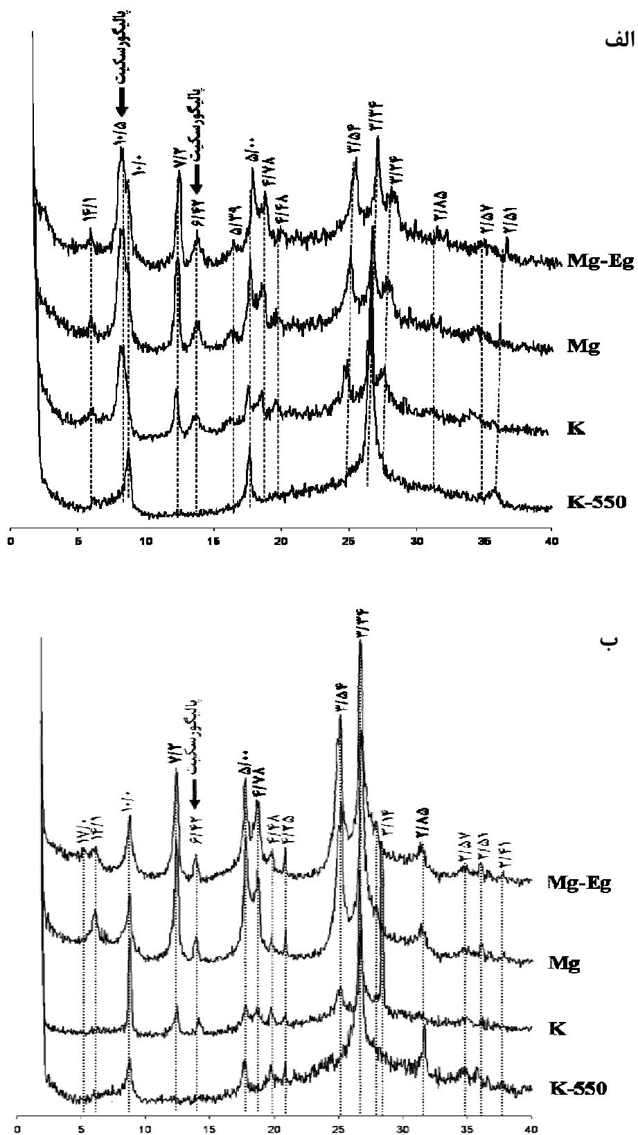
شکل ۲ پراش نگاشتهای پرتو ایکس در بخش رس (الف) افق By از نیمرخ شماره‌ی (۳) و (ب) افق Bk1 از نیمرخ شماره‌ی (۶). Mg-Eg = نمونه‌ی اشباع شده با منیزیوم و اتیلن گلیکول، Mg = نمونه‌ی اشباع شده با منیزیوم، K = نمونه‌ی اشباع شده با پتانسیم و K-550 = نمونه اشباع شده با پتانسیم پس از گرمایی دادن تا ۵۵۰ درجه سانتیگراد. اعداد قله‌ها بر حسب آنگستروم ارائه شده‌اند.
