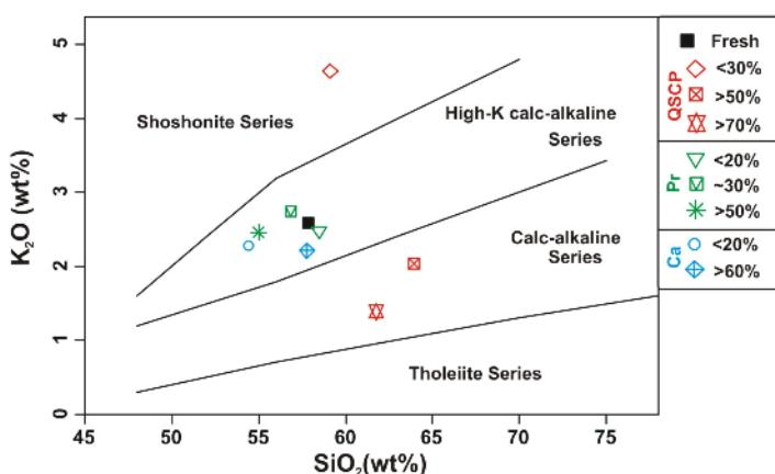
شکل ۹ تعیین سری ماقمایی توده‌ی هورنبلند مونزونیت پورفیری در شرایط دگرسانی‌های کوارتز-سرسیت-کربنات-پیریت، پروپلیتیک و کربناته با شدت‌های مختلف در نمودار پکسربیلو و تیلور [۲۲].
