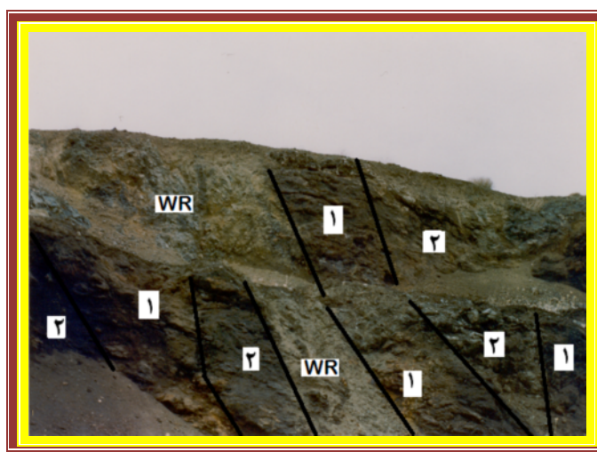
شکل ۴ مرز غربی کانسار برشی گلالی با سنگ دیواره‌ی سالم و فاقد آثار برشی (WR). (H) = کانسار پرعیار فاز ۱ BH = کانسار برشی فاز ۱، L = ذخیره کم عیار فاز ۲.
