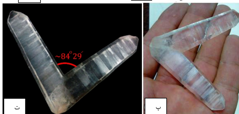
شکل ۱۶ دوقلویی با قاعده‌ی ژاپنی در بلورهای کوارتز. (الف) سطح مشترک جدا کننده دو بلور کوارتز با قاعده ژاپن بصورت خطی و صاف است [۱۱]، (ب) مرز غیر خطی در دو کوارتز با قاعده‌ی ژاپن [۱۱]، (پ) کوارتز شناسایی شده با ماکل قاعده‌ی ژاپن در منطقه قهرود (اندازه هر بلور کوارتز در حدود ۷ سانتی متر است)، (ت) دوقلویی در کوارتز قهرود با قاعده ژاپن. زاویه‌ی اندازه گیری شده بین دو سطح متصل به هم تقریباً برابر با ۸۴ درجه و ۲۹ دقیقه است.
