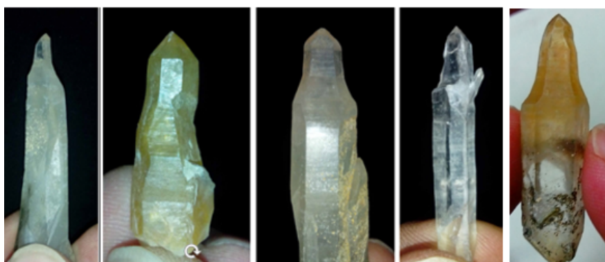
شکل ۱۴ بلورهای کوارتز با رشد موازی- وارون نسبت به محور C بلور در کوارتزهای بلوری قهرود.
