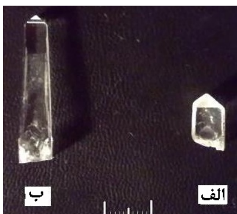
شکل ۴ الف: بلور رشد داده شده از محلول خالص KDP و ب: از محلول KDP با \text{Al}(\text{NO}_3)_3 ۰/۰۰۱ wt%.
