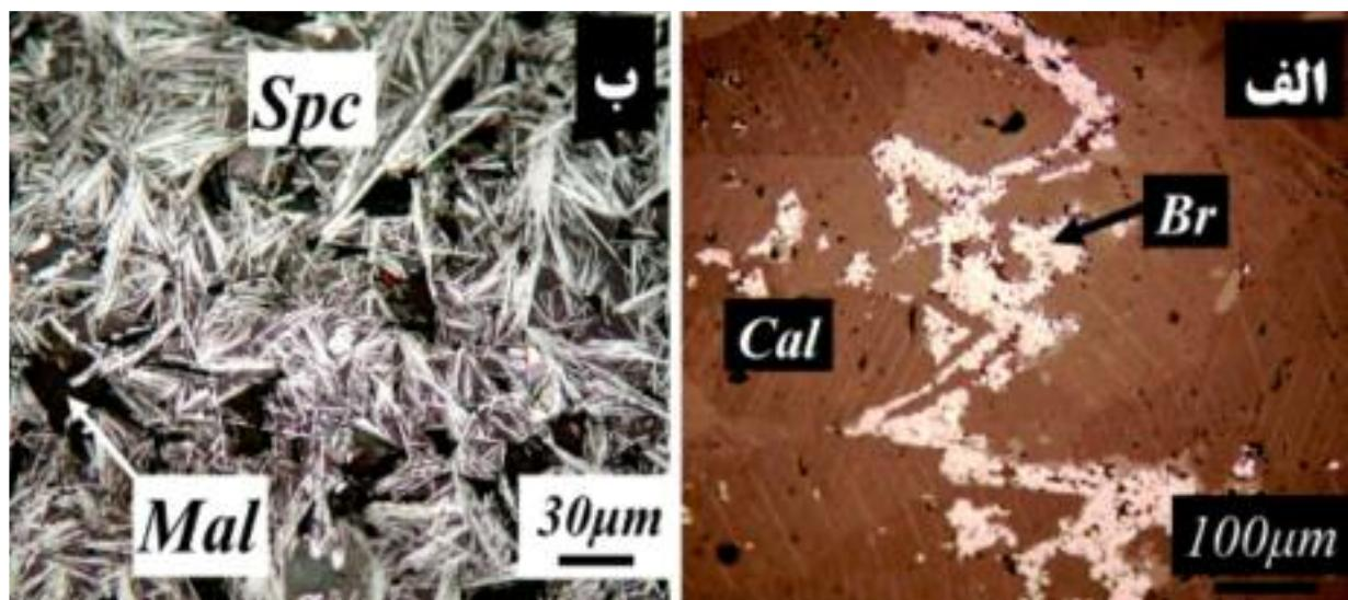
شکل ۸ (الف) براونیت (Br) در مرز بلورهای کلسیت (Cal) و رخهای موجود نفوذ کرده و به پیروی از این نقاط ضعف بلوری، بافت میکرواستیلویلت به خود گرفته است، نور بازتابی طبیعی، در هوای (ب) بلورهای سوزنی - میله‌ای اسپیکیولاریت (Spc) در زمینه‌ی مالاکیت (Mal). نور بازتابی، طبیعی، در هوای
