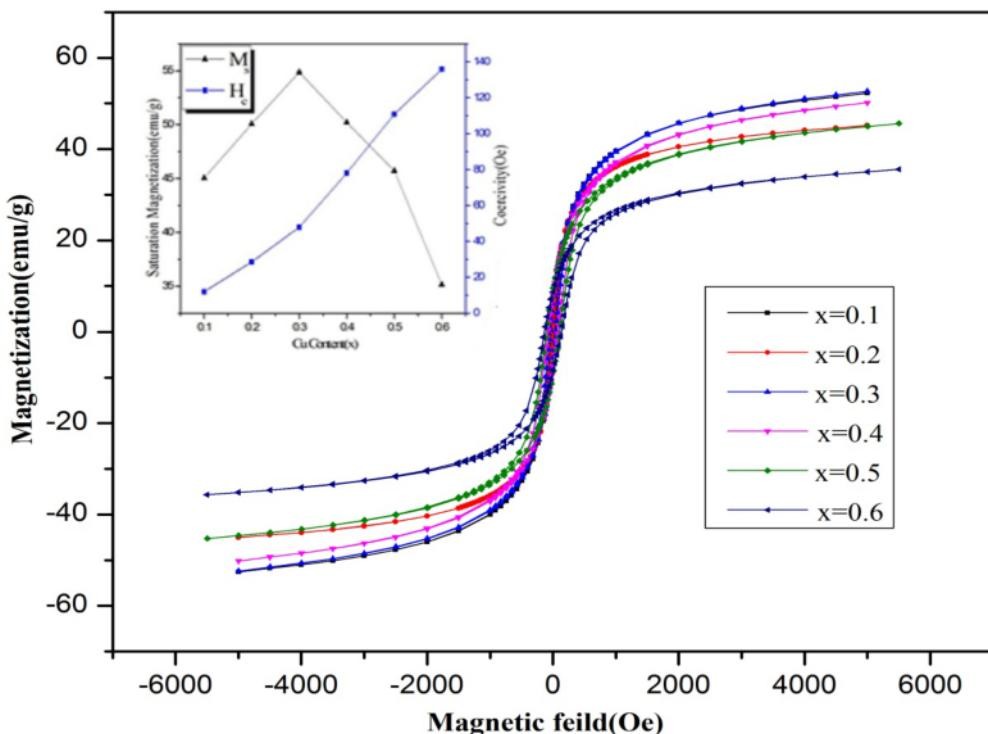
شکل ۷ منحنی پسماند مغناطیسی ذرات پخته شده با ترکیب  $\text{Ni}_{0.3}\text{Zn}_{0.7-x}\text{Cu}_x\text{Fe}_2\text{O}_4$  بر حسب میزان مس جانشانی شده.
