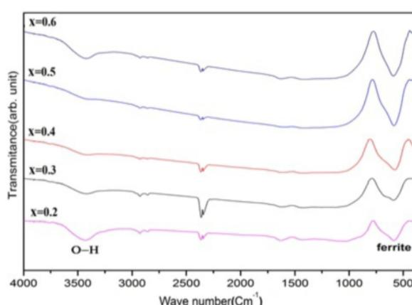
شکل ۴ طیف بینابستنگ فروسرخ نانوذرات گرمایی داده شده در  $1000^{\circ}\text{C}$   $\text{Ni}_{0.3}\text{Zn}_{0.7-x}\text{Cu}_x\text{Fe}_2\text{O}_4$
