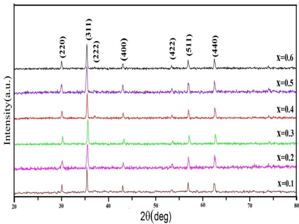
شکل ۲ پراش پرتو ایکس نانوذرات  $\text{Ni}_{0.7-x}\text{Zn}_{0.3}\text{Cu}_x\text{Fe}_2\text{O}_4$  گرما داده شده در  $1000^\circ\text{C}$ .
