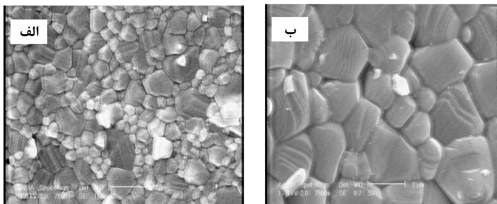
شکل ۵ تصاویر SEM نانوذرات فریت نیکل روی مس با ترکیب (الف)  $x = 0.2$  و (ب)  $x = 0.6$  پخته شده در دمای  $1000^{\circ}\text{C}$
