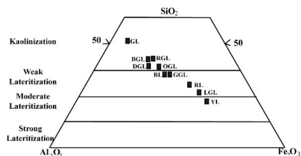
[۳۸]  $\text{Al}_2\text{O}_3\text{-Fe}_2\text{O}_3\text{-SiO}_2$  که شدت فرایند لاتریتی شدن در واحدهای مختلف نهشته‌ی زان را نشان می‌دهد.
