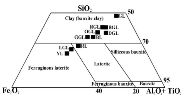
[۱۷]  $\text{SiO}_2\text{-Fe}_2\text{O}_3\text{-}(\text{Al}_2\text{O}_3 + \text{TiO}_2)$  متغیرهای که روند تکامل لاتریتی شدن را نشان می‌دهد.
