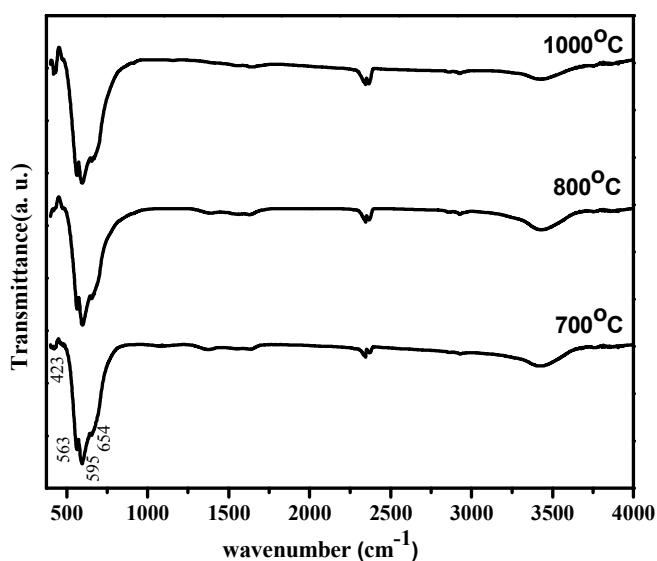
شکل ۴ الگوهای FT-IR مربوط به ژل پخته شده در دماهای  $1000^{\circ}\text{C}$ ،  $800^{\circ}\text{C}$ ،  $700^{\circ}\text{C}$  و  $700^{\circ}\text{C}$ ،  $800^{\circ}\text{C}$  و  $1000^{\circ}\text{C}$ .
