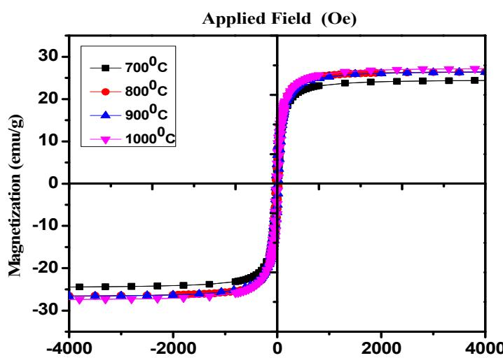
شکل ۶ منحنی پسماند مغناطیسی برای نمونه‌های پخته شده در دمای ۷۰۰°C، ۸۰۰°C، ۹۰۰°C و ۱۰۰۰°C
