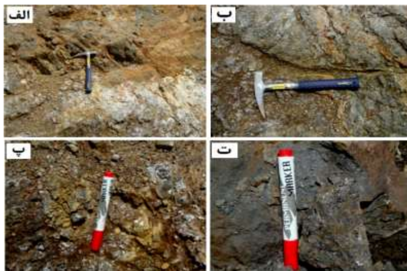
شکل ۲ تصاویر عدسی‌های سولفیدی موجود در داخل گابروها. در تصاویر الف، ب و پ آثاری از هوازدگی به گوشتیت مشاهده می‌شوند.
