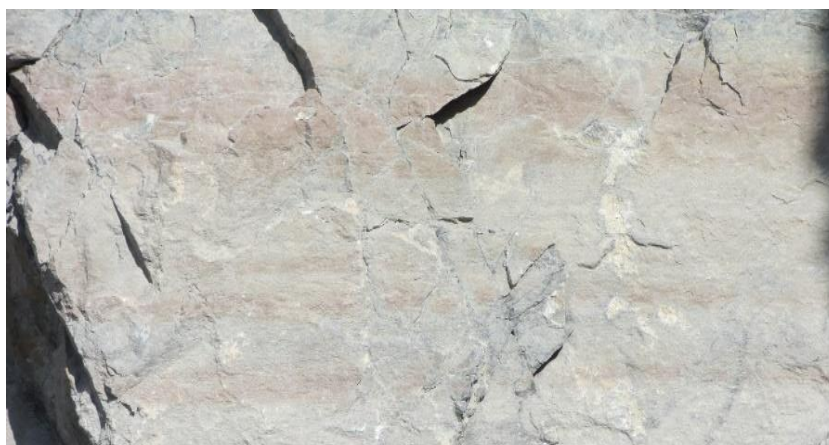
شکل ۱۰ تبدیل بخشی از مگنتیت به هماتیت در اثر دگرسانی.
