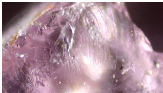
شکل ۱۲ تصویر سطح لعل بدخشان افغانستان با دوربین میکروسکوپ رامان.
