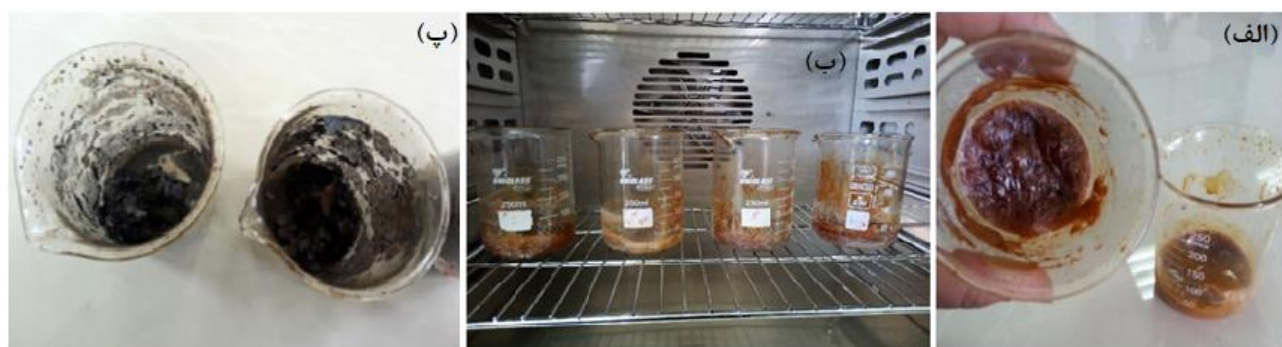
شکل ۱ (الف) تصویر ژله‌ای شدن محلول نهایی، (ب) خشک شدن ماده‌ی ژله‌ای در کوره، (پ) مواد ژله‌ای خشک شده.
