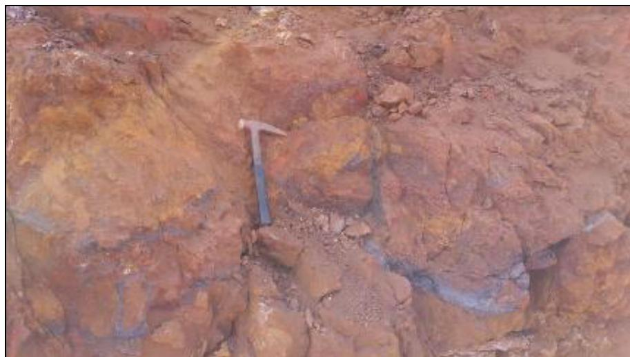
شکل ۳ نمایی از رخمنون گسلی و شکستگی‌های با روند غالب شمال‌غرب-جنوب‌شرق در ذخیره آهن تنگ زاغ.
