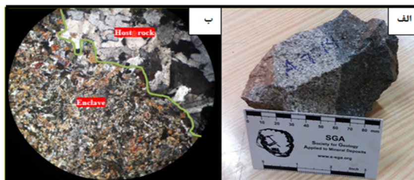
شکل ۳ مرز ناگهانی بین سنگ میزبان و برونوم در الف) نمونه دستی و ب) نمونه میکروسکوپی.
