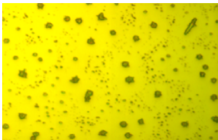
شکل ۵ تصویر میکروسکوپ نوری از نقاط کوانتومی گرافن کلوخه شده بر زیرلایه.
