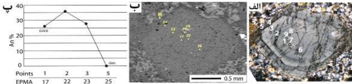
شکل ۱۰ الف) تصویر xPI میکروسکوپ قطبشی و ب) تصویر الکترون‌های پس پراکنده از مقاطع تجزیه شده با دستگاه EPMA در پلاژیوکلاز دارای منطقه‌بندی. پ) نمودار درصد آنورتیت که درصد آنورتیت در هسته حدود ۲۵ است و در منطقه رشدی لبه به ۳۵ درصد می‌رسد در محل ۲۲ (نقطه ۲)، همراه با آثار خوردگی، مقدار آنورتیت افزایش چشمگیری دارد.
