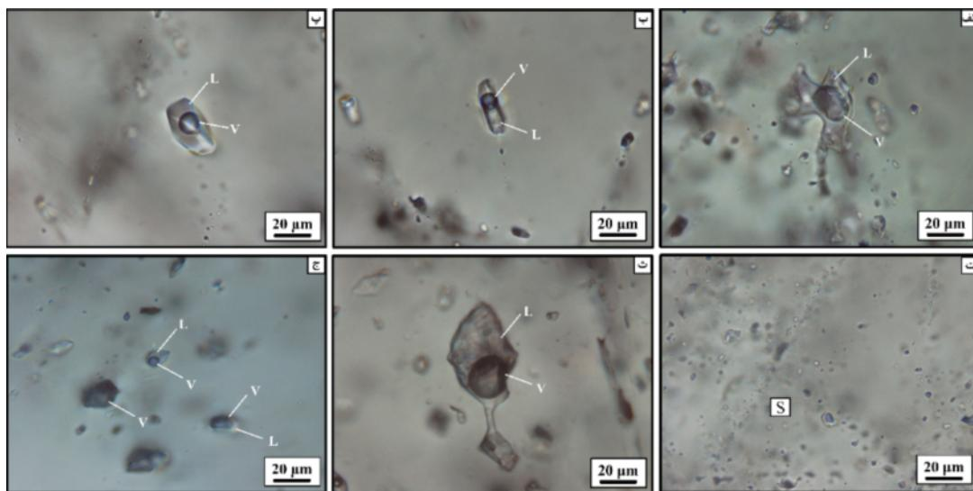
شکل ۵ تصاویر میکروسکوپی از میانبارهای سیال در بلورهای کوارتز منطقه قره‌چای: (الف) میانبار سیال دوفازی غنی از مایع با شکل نامنظم، (ب) میانبار سیال دوفازی غنی از مایع با شکل کشیده، (پ) میانبار سیال دوفازی غنی از مایع بیضوی شکل، (ت) میانبارهای سیال ثانویه که مانند دانه‌های تسبیح پشت سر هم ردیف شده‌اند، (ث) میانبار سیالی که دچار دمبریدگی شده است و (ج) حضور همزمان میانبارهای سیال دوفازی غنی از مایع، تک‌غازی گاز و دوفازی غنی از گاز.
