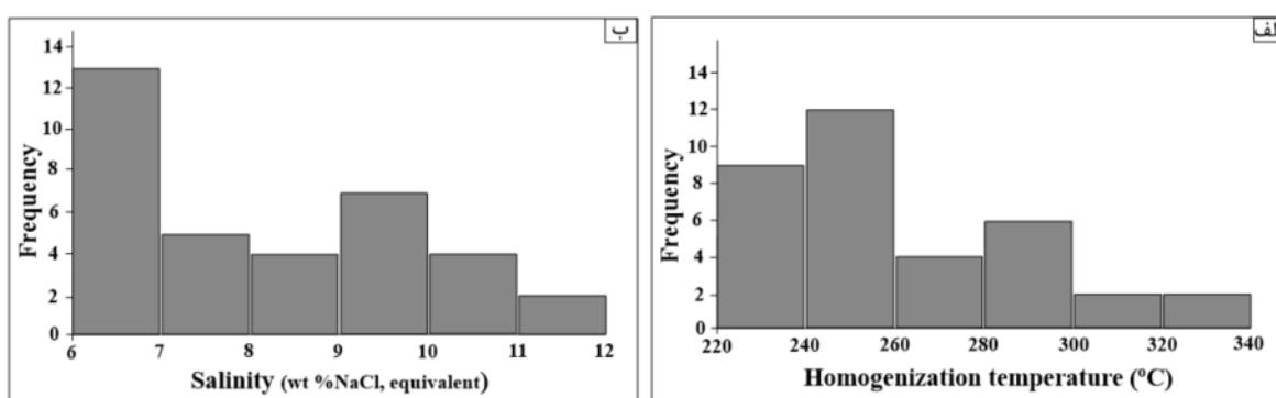
شکل ۶ (الف) نمودارهای ستونی دمای همگن شدگی و (ب) شوری میانبارهای سیال دوفازی غنی از مایع نسبت به فراوانی آنها.
