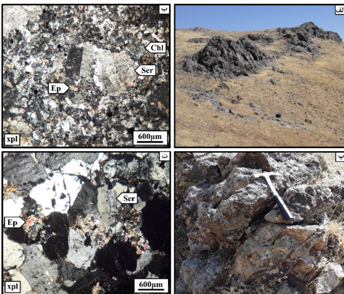
شکل ۲ تصاویر صحرایی و میکروسکوپی از واحدهای سنگی منطقه قره‌چای: (الف) نمایی از رخنمون واحد آندزیت پورفیری، (ب) کانی کلریت ناشی از تجزیه کانی‌های فرومینیزین و همچنین دگرسانی پلازیوکلاز به سریسیت، کانی‌های رسی و اپیدوت در واحد آندزیتی، (پ) رخنمون صحرایی از واحد گرانیت-گرانیت قلیایی، (ت) دگرسانی بخشی فلدسپارها به سریسیت و اپیدوت در واحد سنگی گرانیت-گرانیت قلیایی. نام اختصاری کانی‌ها برگرفته از مرجع [۹] است. (Chl: کلریت، Ser: سریسیت و Ep: اپیدوت)
