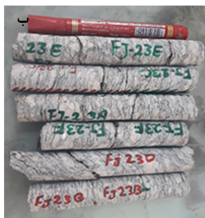
شکل ۶ الف) مجموعه وسایل مورد نیاز برای نمونه برداری (به روش مغزه‌گیری)، و ب) تصویری از چند عدد مغزه گرفته شده از گرانیت‌های به شدت دگرشکل شده چاه‌زرد (سمت چپ).
