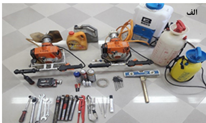
شکل ۶ الف) مجموعه وسایل مورد نیاز برای نمونه برداری (به روش مغزه‌گیری)، و ب) تصویری از چند عدد مغزه گرفته شده از گرانیت‌های به شدت دگرشکل شده چاه‌زرد (سمت چپ).
