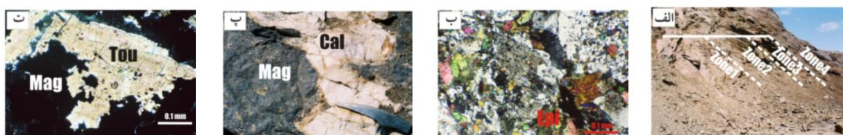
شکل ۳ (الف) محل پهنه‌های کوارتز سینیت آلتره شده و اپیدوت کوارتز سینیت (ب) اپیدوت جانشین شده با مگنتیت در پهنه‌ی ۳. (پ) جانشینی کلسیت به وسیله‌ی مگنتیت. ت) جانشینی تورمالین به وسیله‌ی مگنتیت در پهنه‌ی ۴.
