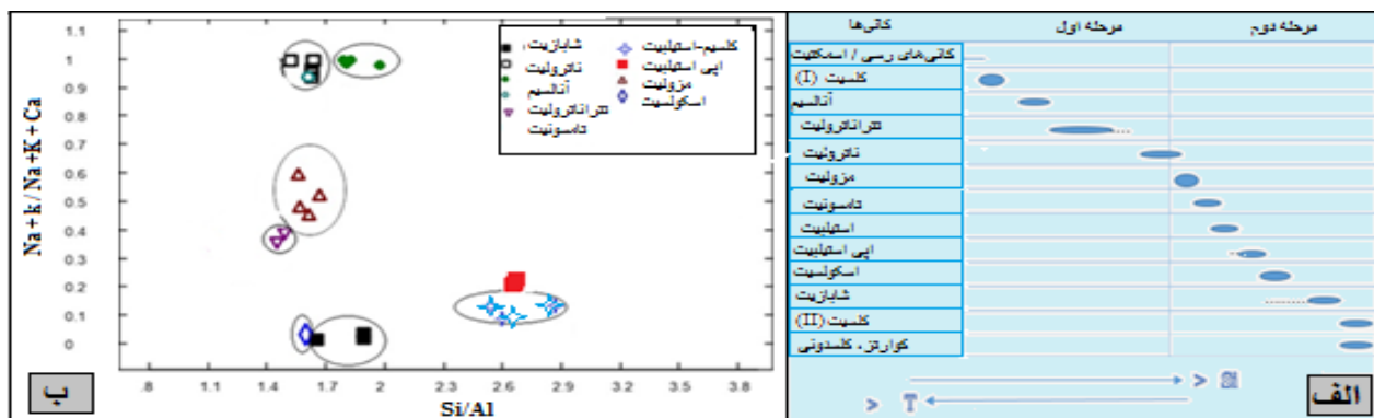
شکل ۶ الف- نمودار \text{Si/Al} نسبت به \text{Na+K/(Na+K+Ca)} برای تعیین ترکیب ژئولیت‌ها در منطقه پرندک که تغییرات گسترده‌ای را در نسبت \text{Na+K/(Na+K+Ca)} نشان می‌دهد و ب- توالی تبلور ژئولیت‌ها در حفره‌ها و شکستگی‌ها سنگ‌های بازی منطقه پرندک.
