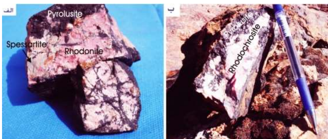
شکل ۵ تصاویر نمونه دستی کانسنگ منگنز توکلان: الف: کانسنگ دارای رودونیت، اسپسارتیت و پیرولولزیت و ب) کانسنگ دارای رودوکروزیت (سفید صورتی) و پیرولولزیت (سیاه). پیرولولزیت شکستگی‌های سنگ مادر را پر کرده است.
