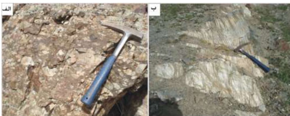
شکل ۲ الف) آگلومرا متشکل از قطعات ریولیت و داسیت به صورت میان‌لایه با متاولکانیت‌ها و ب) سربست شیت دارای شیت وارگی و نوارشکنجی. مقطع میکروسکوپی سربست شیت در شکل ۳ نشان داده شده است.
