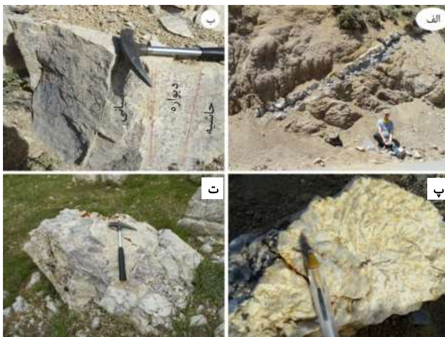
شکل ۳ رخمون‌های دایک‌های پگماتیت موجود در گستره‌ی مورد بررسی: الف) رگه پگماتیتی در سنگ میزبان هورنفلسی، ب) منطقه‌بندی پگماتیت، پ) شواهد بافت گرافیکی در فلدسپات‌های پگماتیت‌ها، ت) پهنه درشت‌بلور هسته شامل کوارتز صورتی.
