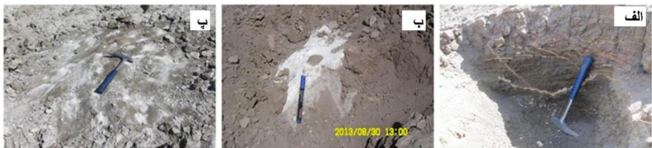
شکل ۴ الف- سولفات‌سدیم در عمق ۴۰ تا ۳۰ سانتی‌متری، ب و پ در قسمت‌های سطحی.
