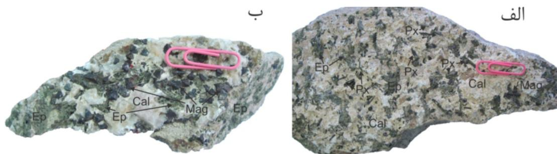
شکل ۳ الف) نمونه دستی رگچه کلسیت- اپیدوت- مگنتیت- پیروکسن تشکیل شده در سطح درزه سنگ میزبان، ب) نمونه دستی رگچه مگنتیت- کلسیت- اپیدوت (Mag=مگنتیت، Cal=کلسیت، Ep=اپیدوت، Px=پیروکسن [۱۹]).
