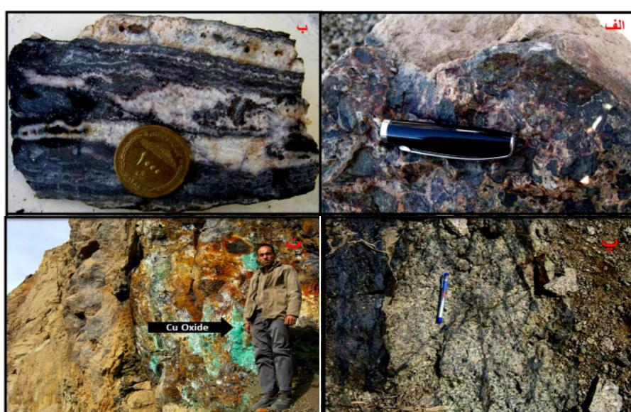
شکل ۱۵ حالتهای مختلف کانی‌سازی. (الف) برش گرمابی، (ب) لایه‌ای-شانه‌ای، (پ) داربستی و (ت) کانی‌زایی کربنات‌های مس (آزوریت و مالاکیت) همراه با کانی‌زایی آهن در منطقه.
