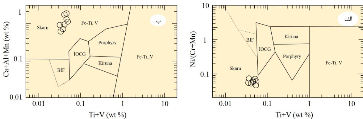
شکل ۱۰ (الف) نمودار تغییرات  $\text{Ni}/(\text{Cr}+\text{Mn})$  نسبت به  $\text{Ti}+\text{V}$  که نشان دهنده ارتباط نمونه‌های کانسار آهن دردوانی با کانسار نوع اسکارن است، (ب) نمودار تغییرات  $\text{Ca}+\text{Al}+\text{Mn}$  نسبت به  $\text{Ti}+\text{V}$  که قرار گرفتن کانسار دردوانی در گسترده‌ی اسکارن را نشان داده است [۲۴].
