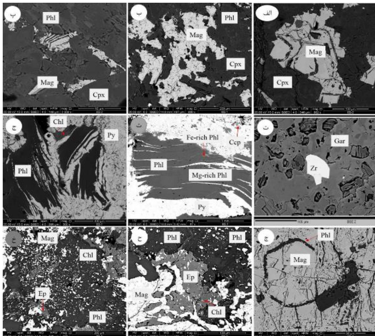
شکل ۶ تصاویر میکروسکوپ الکترونی از کانی‌های تشکیل شده در اسکارن دردوى: الف تا پ) همراهی مگنتیت با کلینوپیروکسن (Cpx) و فلوگوپیت، ت) میانبار زیرکن (Zr) در گارنت، ث) منطقه‌بندی در بلور فلوگوپیت، ج) فلوگوپیت، کلریت و پیریت (Py)، (ج) رورشدی فلوگوپیت بر بلور مگنتیت، و (خ) اپیدوت، فلوگوپیت و کلریت که فراوانترین کانی‌های سیلیکاته همراه با مگنتیت در اسکارن پسرونده هستند.
