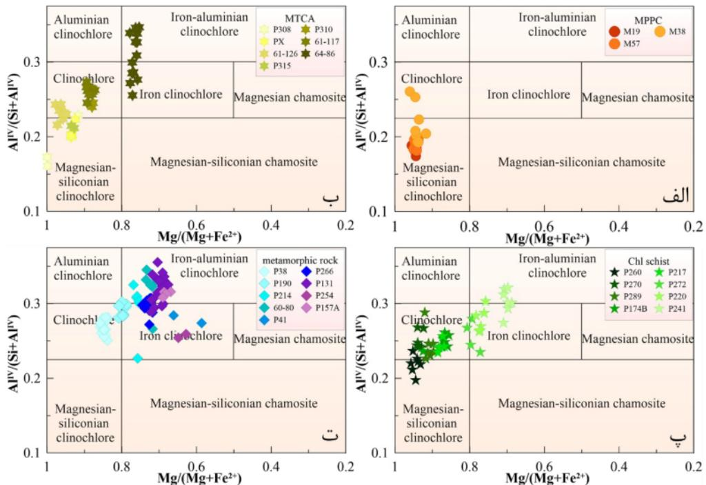
شکل ۵ نمودار  $Al^{IV}/(Si+Al^{IV})$  نسبت به  $Mg/(Mg+Fe^{2+})$  اصلاح شده [۳۹] برای مقایسه ترکیب کلریت‌ها در نمونه‌های مختلف. الف) پهنه MPPC، ب) پهنه MTCA، پ) کلریت‌شیست، ت) سنگ‌های دگرگونی.
