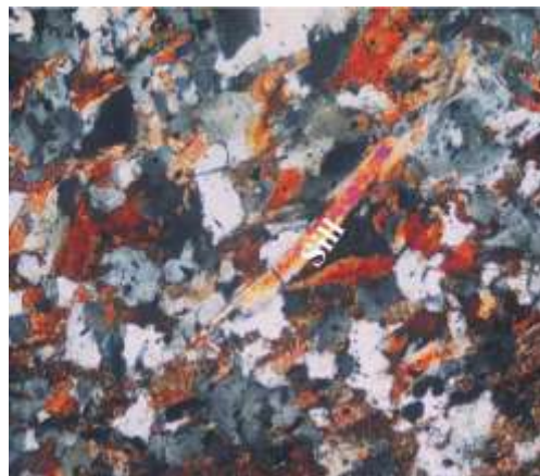
شکل ۶ بلورهای منشوری طویل سیلیمانیت (sill) تشکیل شده در زمینه سنگ. عرض عکس برابر با ۳/۵ میلیمتر است.
