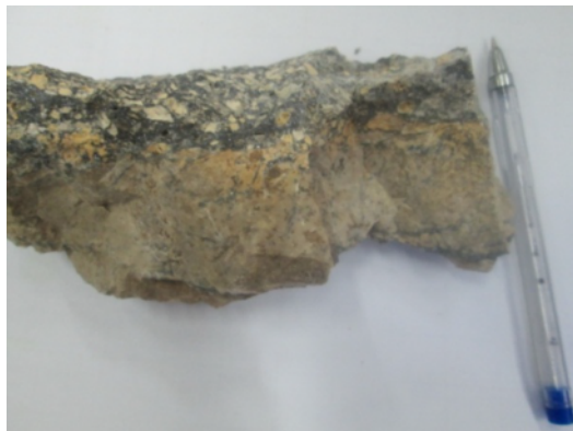
شکل ۱۶: نمایی از ماده معدنی با بافت افشان و رگه‌ای.
